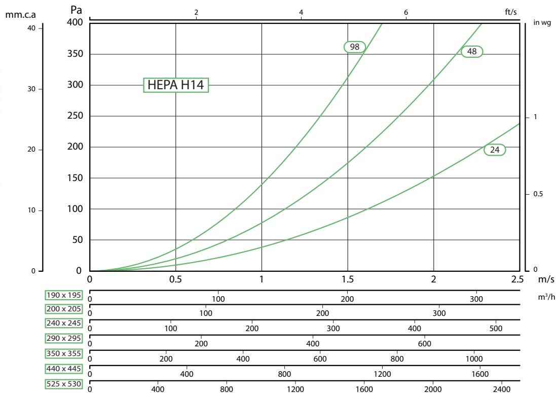
Q = Caudal en (m<sup>3</sup>/h), (m<sup>3</sup>/s) y c.f.m. / Q = Airflow in (m<sup>3</sup>/h), (m<sup>3</sup>/s) and c.f.m. / Q = Débit en (m<sup>3</sup>/h), (m<sup>3</sup>/s) et c.f.m.
